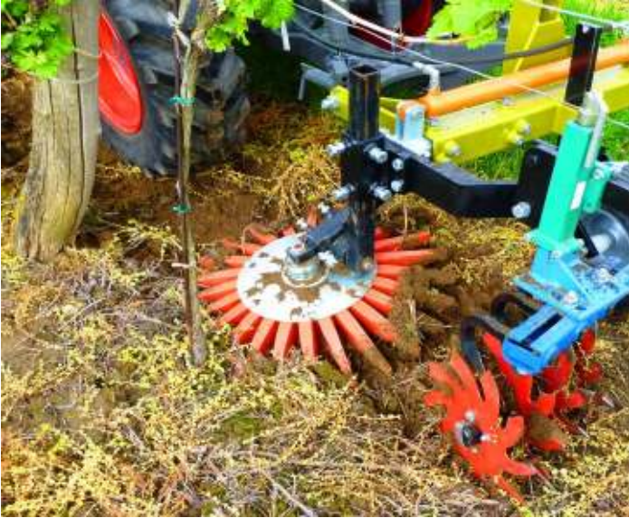
Bineuse à Doigts MAXI Ø 700 mm, rouge (très rigide) Largeur entre rangs à partir de 150 cm
