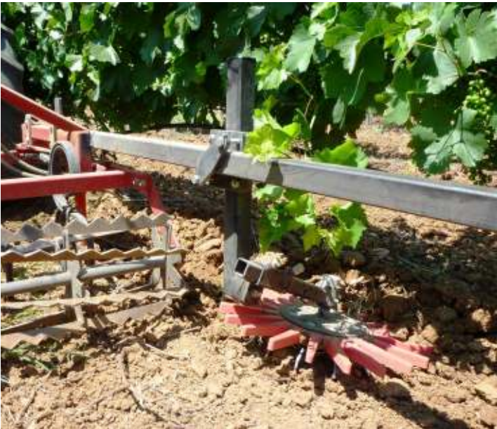
Bineuse à Doigts Mini-MAXI Ø 540 mm, rouge (rigide) Largeur entre rangs dès 90 cm
