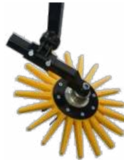
Version MAXI 1000 pour Arboriculture Ø 950 mm avec moyeux très ren- forcés Doigts jaunes (rigides) ou oranges (souples) Pour arbres jusqu'à 20 cm
